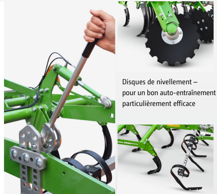
Réglage manuel de l'unité de nivellement via segment perforé
