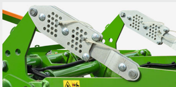
Réglage mécanique de la profondeur de travail
